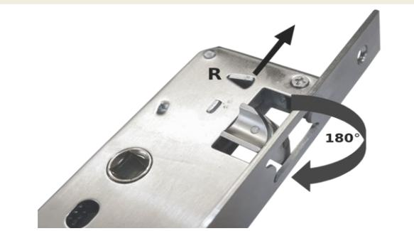
**1.4** Setzen Sie das Einsteckschloss in die Ausfräsung des Tores ein. Führen Sie den Vierkantstift in die Nuss des Schlosskastens. Stecken Sie die beiden Drücker auf den Vierkantstift und verschrauben Sie diese mit den beigefügten M4 x 45 mm Senkkopf-Schrauben.
