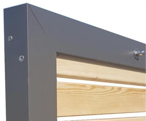
**1.2** Um das Tor fertigzustellen, montieren Sie die Drückergarnitur mithilfe des beiliegenden Montagematerials und die Torbänder mithilfe der M8 Schlossschrauben, Unterlegscheiben und Hutmuttern an das Torblatt.
